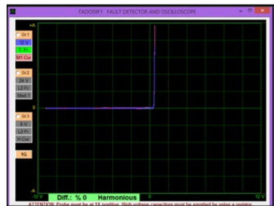
Figura 7: Curvas o firmas básicas de un Diodo.
