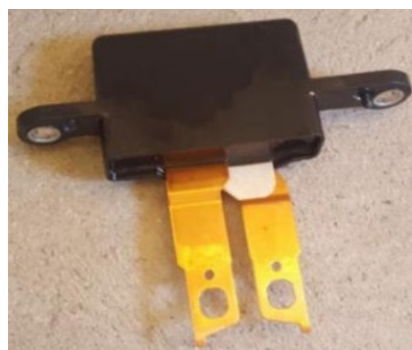
Figura 15: Capacitor Paralelo a la Batería HV - Toyota Prius.
