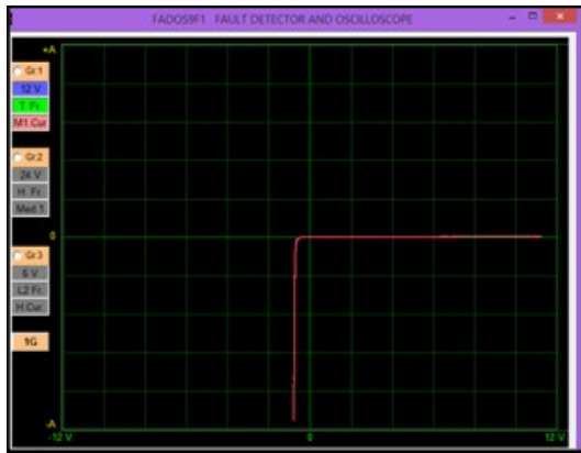
Figura 8: Curvas o firmas básicas de un Diodo Zener.
