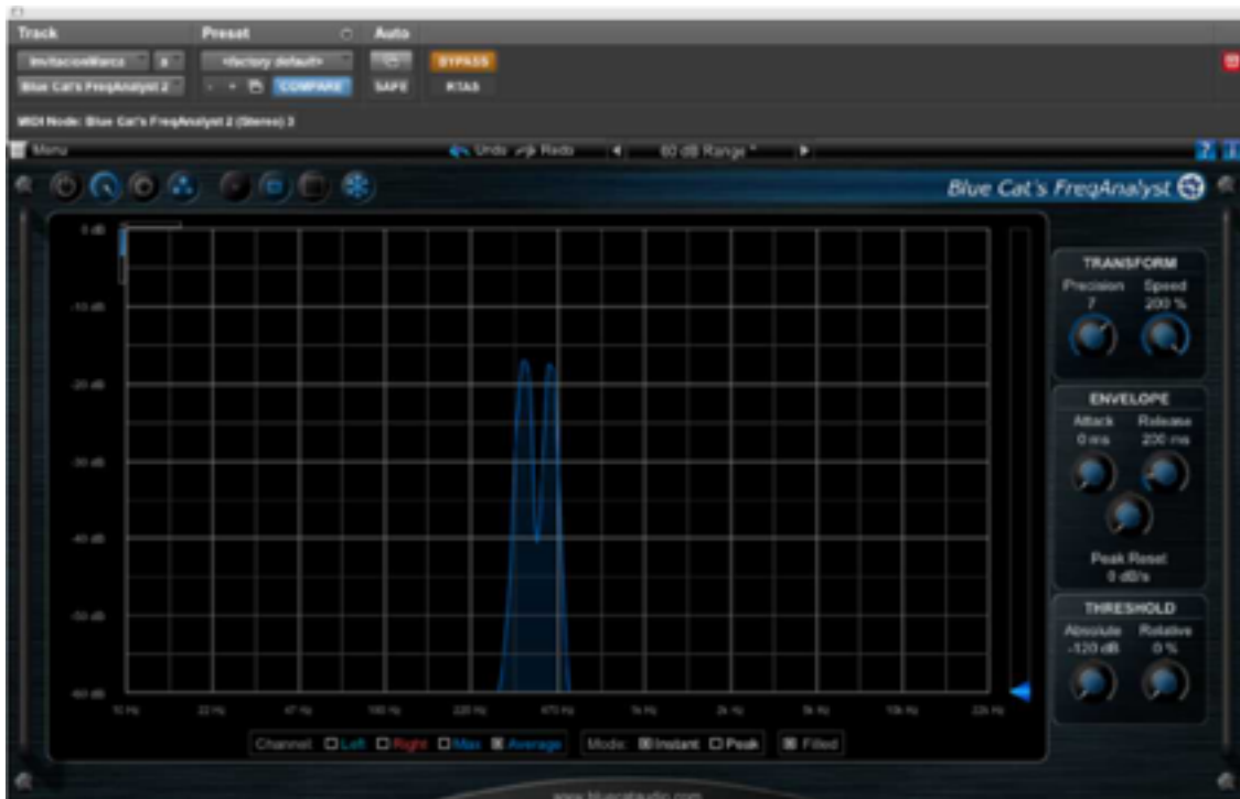
Cap. Pantalla 1. Analizador de espectro Blue Cats/ -60 db Range. Tono de Invitación a Marcar. Países: Canadá y Estados Unidos
