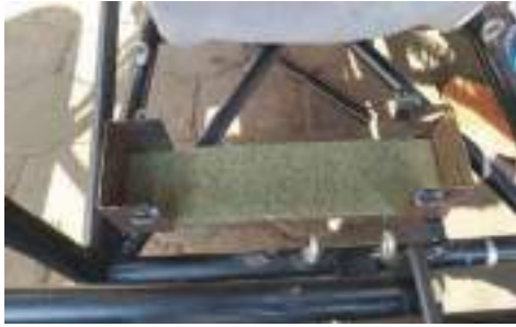
Figura 8: Implementación de base de batería. Fuente: (Autores)
