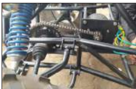
Figura 8: Implementación del motor eléctrico en el bastidor. Fuente: (Autores)
