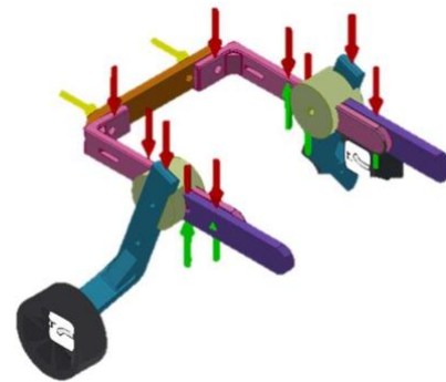
Figura 14: Cargas aplicadas en el carro ortopédico
