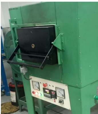
Horno de tratamientos térmicos
