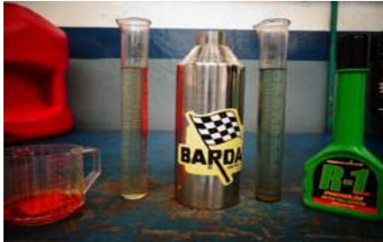
Figura 4. Medición del combustible que ingresará en el sistema cánister
