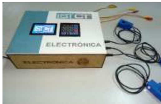
Figura 14. Puesta en funcionamiento prototipo Analizador de Red. Fuente: Elaboración propia
