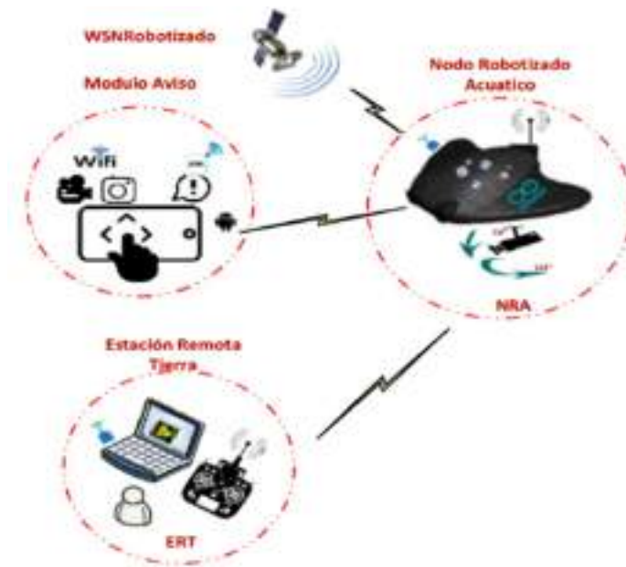
Figura 1: Arquitectura de la WSNRobotizado Fuente: El Autor
