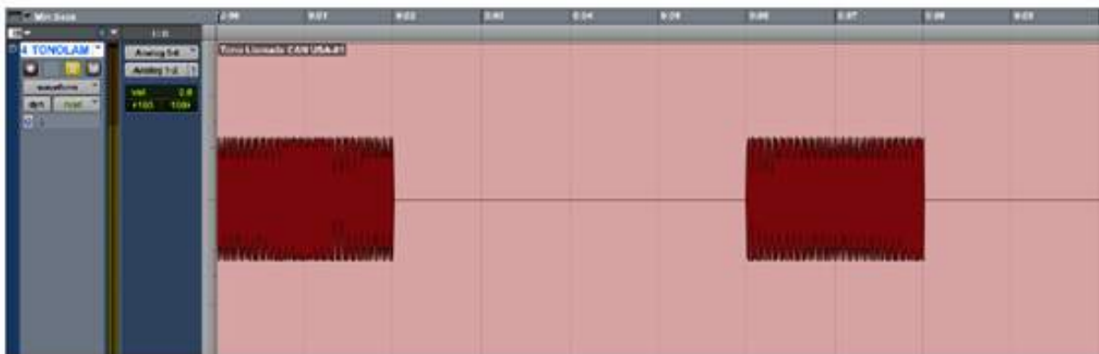
Cap. Pantalla 6. Ventana de Edición de Pro Tools. Cadencia Telefónica Tono de Llamada. Países: Canadá y Estados Unidos.
