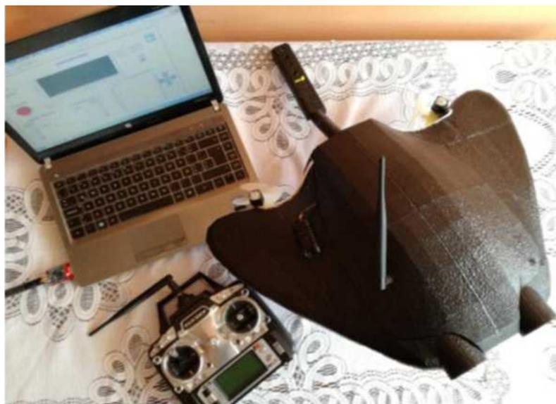
Figura 9. Integración hardware y software de la WSN Robotizado
