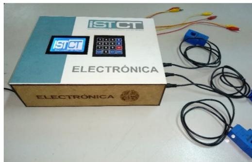
Figura 14. Puesta en funcionamiento prototipo Analizador de Red.
