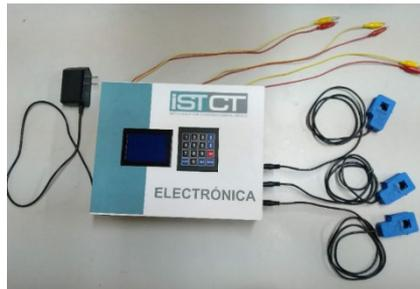
Figura 13. Prototipo de Analizador de Red Trifásica
