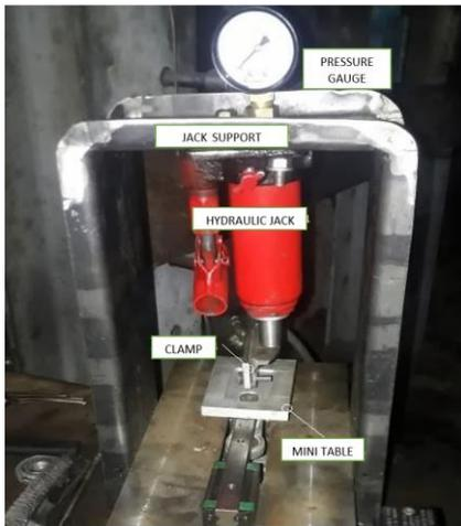
Figura 14: Ensamblado de la mesa elevadora.
