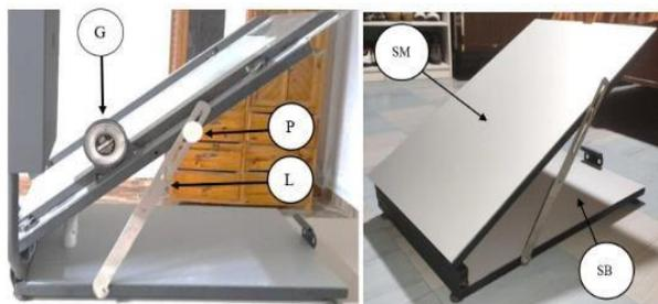
Fig. 2 Superficies, graduador magnético y perilla.
