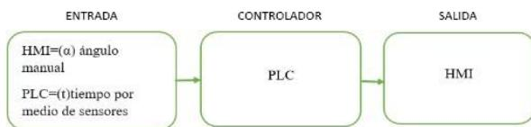
Fig. 4 Diagrama lazo abierto Fuente: Propia
