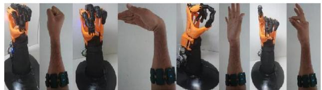
**Figura 7.** Pruebas de ejecución de movimientos correspondientes de izquierda a derecha, Puño cerrado, Agarre, Pinza, Puntero.
