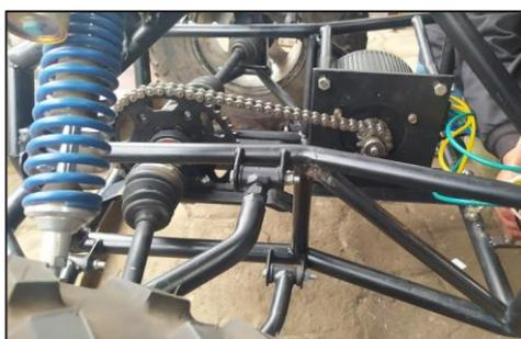
Figura 8: Implementación del motor eléctrico en el bastidor.
