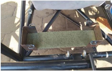
Figura 8: Implementación de base de batería.
