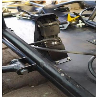
Figura 10: Instalación del pedal de aceleración en parte delantera del bastidor.
