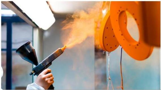
Figura 4. Aplicación de pintura electrostática
