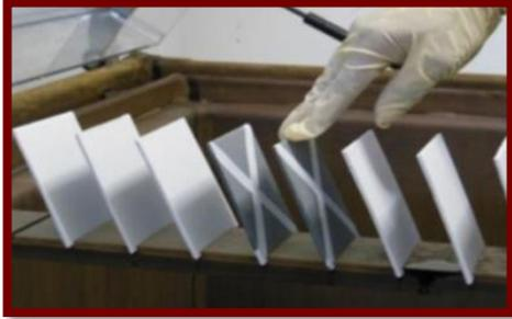
Figura 2: Aplicación de piezas en medio salino.
