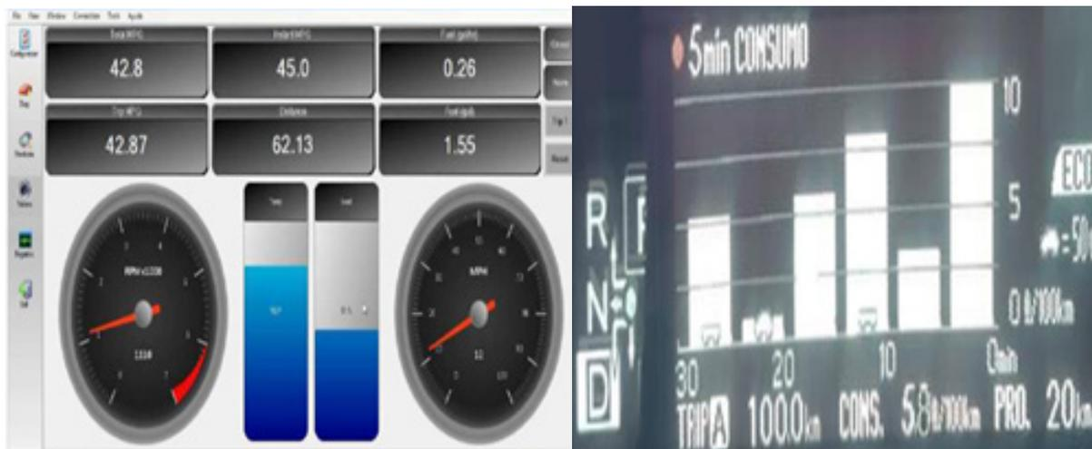
Figura 5: Valores al final de la prueba en ciudad en condiciones híbrido estándar con el interfaz OBDWIZ y el display del vehículo.
