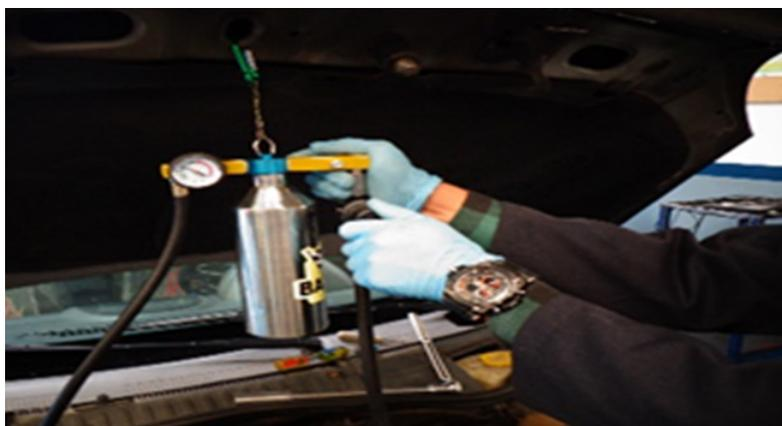
Figura 3. Sistema cánister de limpieza instalado
