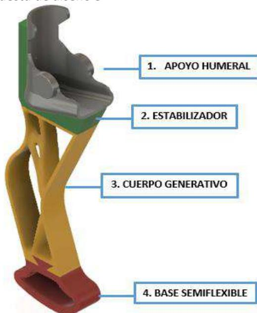
Otro de los factores a tomar en cuenta es la inclinación hacia los 15°, la misma está referenciada en la figura 5, donde se describe la parte de apoyo humeral para evitar que el codo vaya a deslizarse hacia adelante, generando una incomodidad en el movimiento de los canes.
