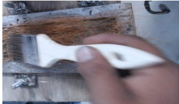
Figura 7: Proceso de impregnación de materiales.
