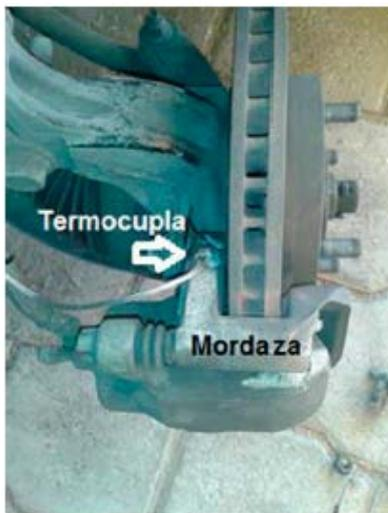
Figura 7: Instalación termocupla en la mordaza de freno delantera Sail S3.
