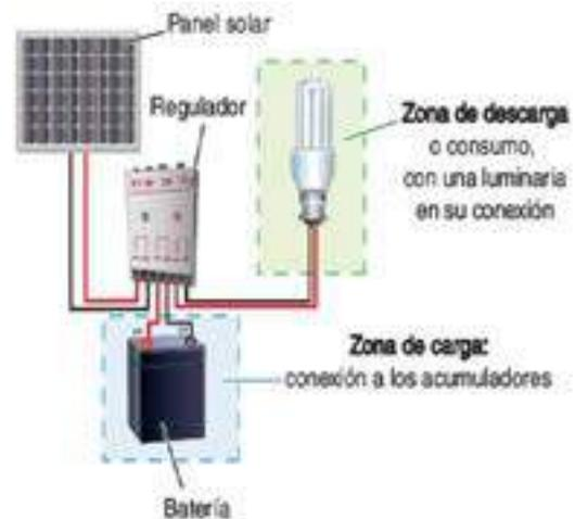
Figura 1: Conexión del regulador con el panel solar
