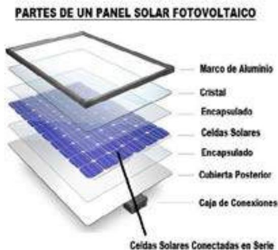
Figura 3: Celda de panel solar
